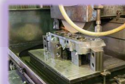
4輪用エンジンブロック 材質:鉄铸件
