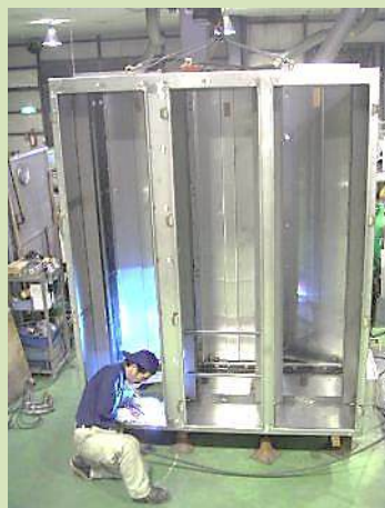
ステンレスの板で 製作した筐体
