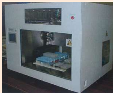
臨床検査4連分注装置 (4ノズル独立移動)
