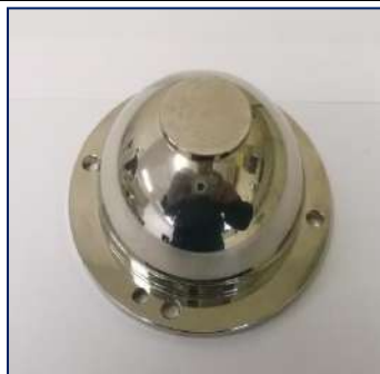
水晶発振子R加工用球面治具
