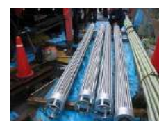
井戸孔挿入型熱交換器
