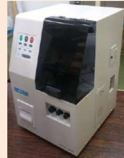
粘度分析装置 (血液のサラサラ度測定)
