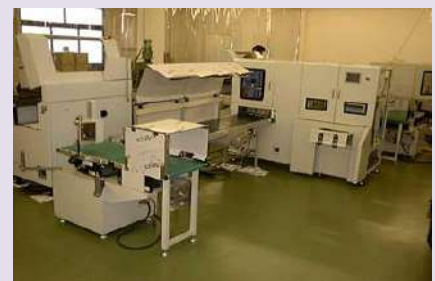
糊付け製本装置 (プリント用紙を自動スタック&背糊付け)
