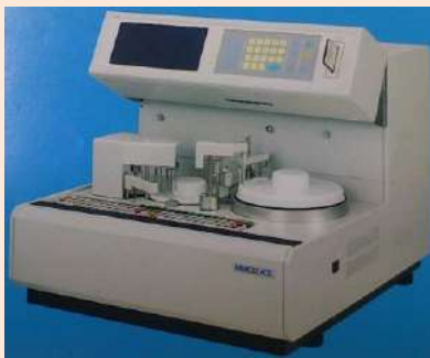
ディスクリット方式自動分析装置 (生化学他の分析対応)
