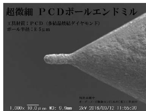
【 超微細ダイヤモンドエンドミル (先端径:0.01mm) 】
