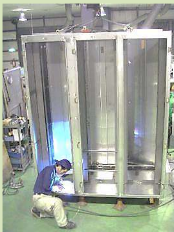
ステンレスの板で 製作した筐体
