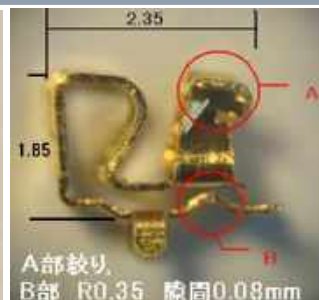
超小型電源端子:C1720-H t=0.12 要求精度 0.003
