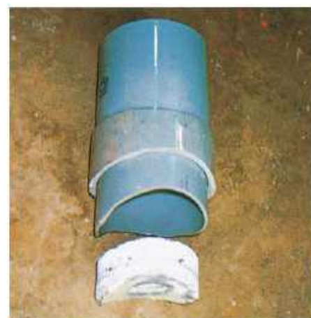
取付部回収コアーの合せ加工
