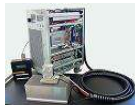
レーザー用電源装置
