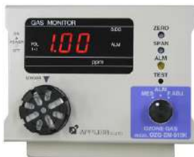
<拡散式オゾンガスモニタ:OZG-EM-010K>
