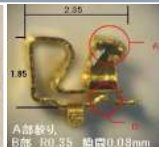
超小型電源端子: C1720-H t=0.12 要求精度 0.003
