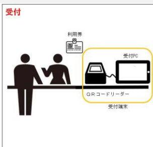
入退館管理システム
