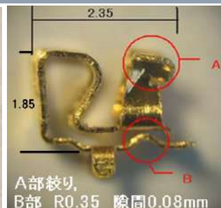
超小型電源端子:C1720-H t=0.12 要求精度 0.003
