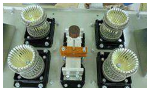
＜電力・原子力機器(遮断器)のユニット組立＞
