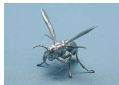
高精度な 5 軸加工サンプル
