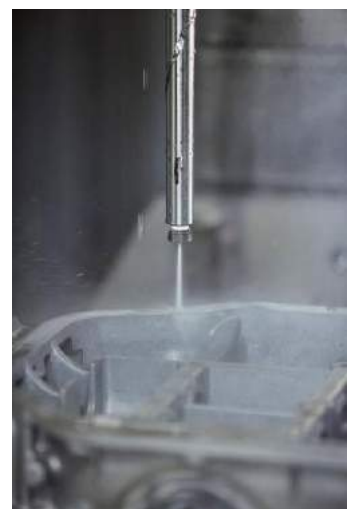
高圧狙い洗浄
