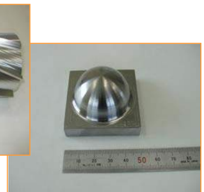
球面加工 材質 NAK55
