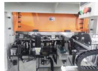
ダブルトランスファー多工程150ton プレス機
