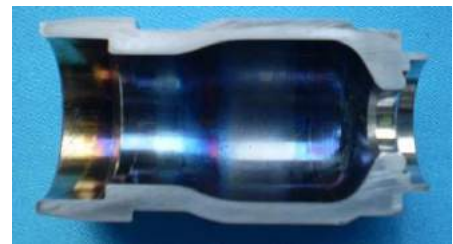
ネックボトル形状に鍛造加工したハウジング
