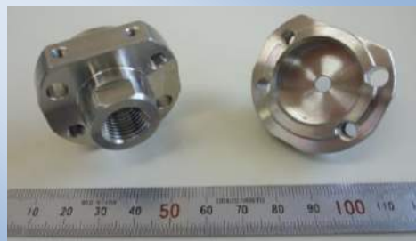
大型棒材複合旋盤による複雑加工 サイズ: \phi 45 材質: SUS304
