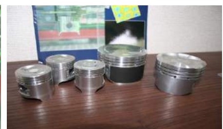
図4 ピストンの特殊レーザピーニング処理の例
