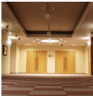
学校：地下ホール(光ダクト)
