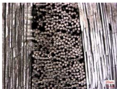
図2 熱可塑性CFRPの切断面
