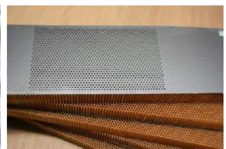
図3 CFRP製超軽量消音パネル
