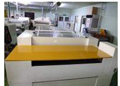
「1000 mm幅まで可能な大型研磨機」
