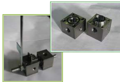
＜鉄(S45C)□60＞ シャフト等組付け 凹凸部組合せ部品 嵌合部精度 0.025 内径精度 0.05
