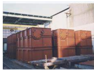
焼却炉用角ダクト 巾・高さ 2.5m 長さ 6m 容量 35 m 3
