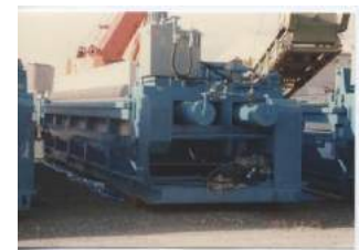
トンネル工事用脱水装置 泥水を分離し脱水
