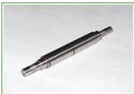
＜ステンレス(SUS400C)＞ 外径 10 x 長さ 90 熱処理後研磨(外注)
