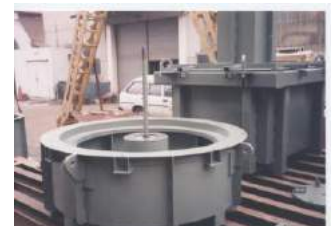
原子力発電用遮蔽容器 内面:鉛 casting 込み
