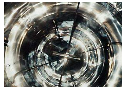
《タンク内面の電解研磨事例》
