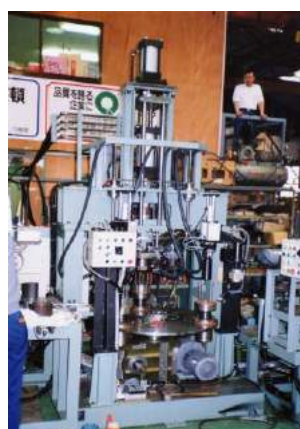
【自動組立溶接装置】 (モーター製造ライン:回転 St 式)
