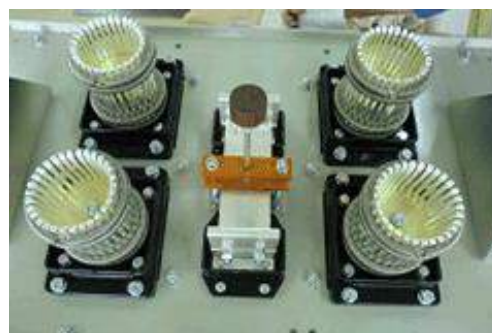
＜電力・原子力機器(遮断器)のユニット組立＞
