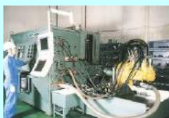
油圧ポンプモーターの 性能確認テスト
