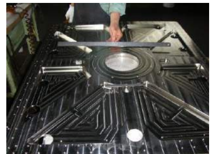
加工例（材料はインコネル）
