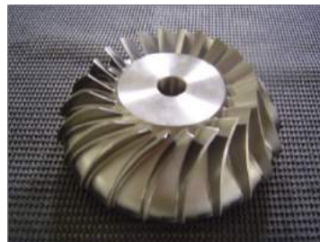
斜流コンプレッサーφ170×52 20枚翼 チタン材 Ti6AL4V (被削性指数 20)
