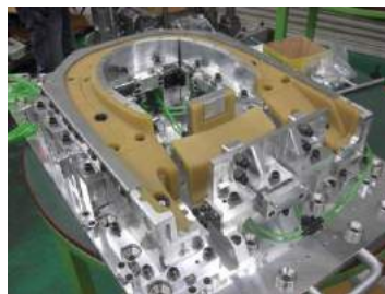
製造例 2：受部 Urethane 溶着治具
