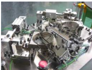
製造例 1：受部 Steel 溶着治具
