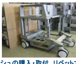
エッジガード取付、樹脂部品取付、りん青銅メッシュの購入・取付、リベットでの組立
