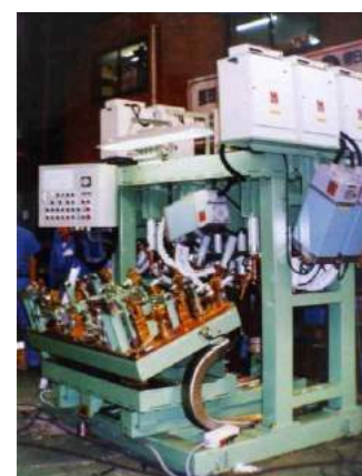
【マルチスポット溶接機】 (自動車部品製造:往復動式)
