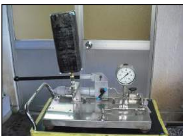
内部圧力試験の様子
