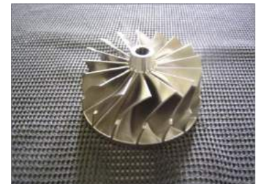
遠心ラジアルタービンφ110×58 22枚翼 超耐熱鋼材 インコネル 718 (被削性指数 8)
