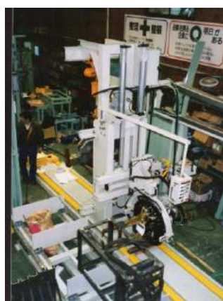
【NC 制御 スポット溶接ロボット】 (電車車両製造ライン:多軸NC)
