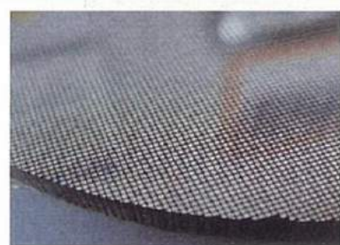
<Siの格子加工、溝幅0.05深さ6.5mm>
