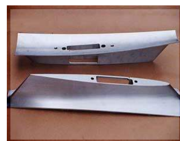
＜航空部品＞ アルミ 6061 三次元加工
