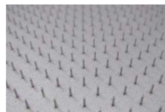
ピン ( \phi 0.65 \pm 0.02 \times 3\text{mm} ) 500本切削。穴あけ・ピン圧入⇒切削で大幅コストダウン
