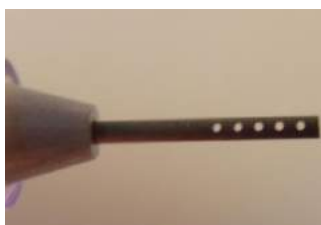
0.5mm シャープペンシルの芯に \phi 0.2\text{mm} 貫通穴を5箇所加工
