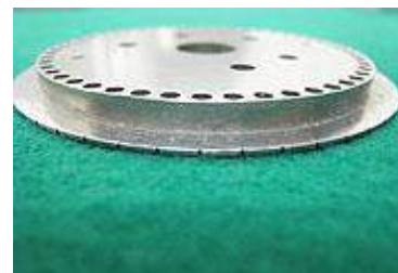
丸物製品の微細穴加工 微細穴と太穴は内部で連結
