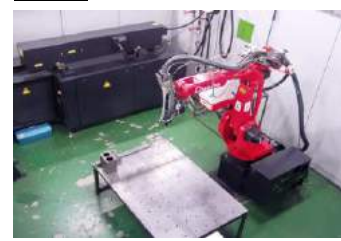
設備:YAGレーザー溶接機
