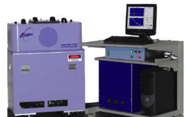
分光分析装置 時系列変換パルス分光法を採用した新しい赤外領域の分光装置(共同開発)
