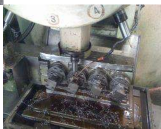
小型マシニングセンター 4連インデックス 加工で生産性を 高めています
