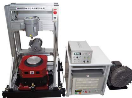
◆開発・製作期間 60 日以下 JR 総合研究所向け起振機 (アクティブマスダンパーとして新幹線の乗り心地向上)
