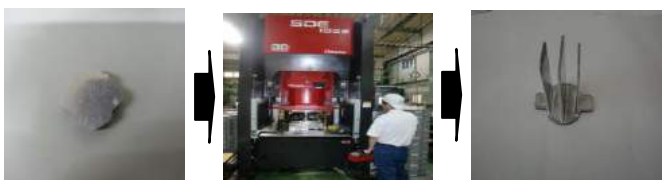
材料 プレス（一回転） この形状に成型
