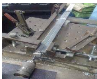
横型ボール盤 長尺物端部の 穴・タップ加工
