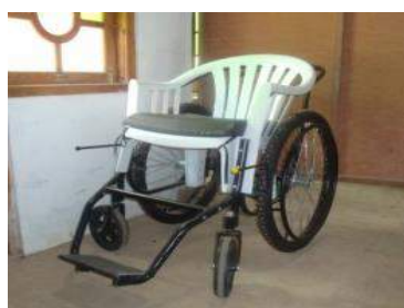
プラスチック製の椅子を改造した車椅子
