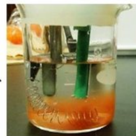
電解の様子(褐色物質が電析したセレン)
